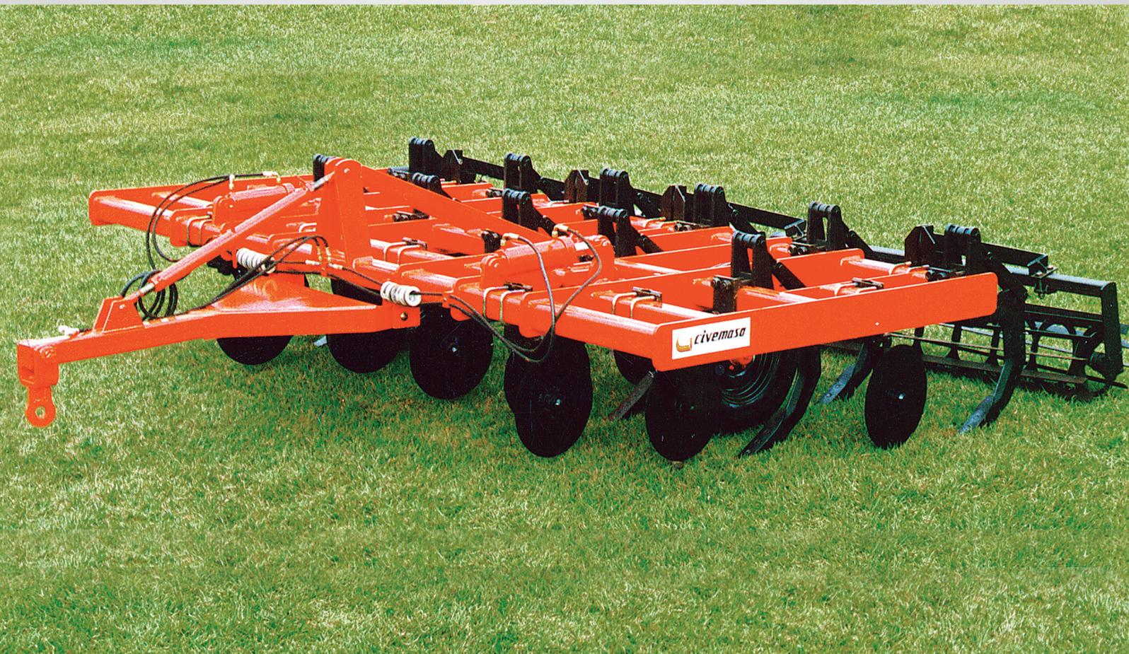
São equipados com discos de corte individuais oscilantes em 18 graus e molas de compensação para os diferentes níveis de profundidade. Desta forma os STAC executam um perfeito trabalho em palhadas dessecadas ou massa verde.
